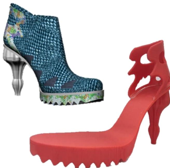
Abb. 5: 3D-gedruckte Prototypen von Schuhkomponenten. Quelle: TUIASI
