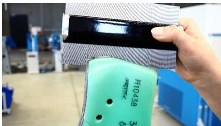
Fig. 7: Configuração do contraforte na forma © PFI
