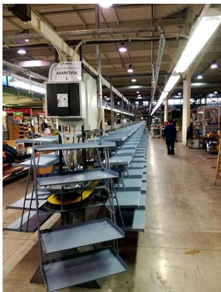
Fig. 16: Transportador com 4 níveis © PFI
