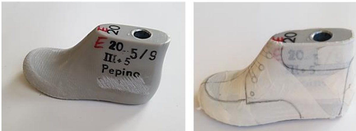
Fig. 2: Calapod și calapod îmbrăcat cu bandă de hârtie pentru obținerea copiei de model © PFI
