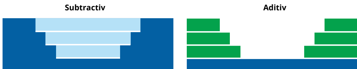
Fig. 7: Stânga: proces substractiv (albastru închis: Partea dorită, albastru deschis: material îndepărtat) | Dreapta: proces aditiv (albastru închis: strat de bază, verde: straturi adăugate) © PFI
