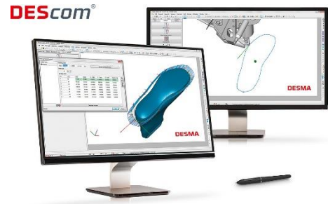
Fig. 5: Sistem CAM DEScom de la DESMA; Programarea unui ciclu de scămoșare pe baza datelor 3D-CAD; vizualizarea traseului și orientării sculei.
