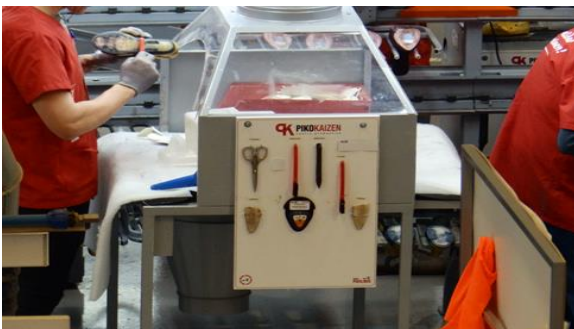
Fig. 24: Plasarea uneltelor necesare operațiilor în curs © PFI
