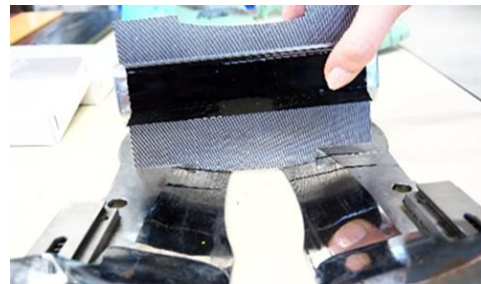
Fig. 6: Forma uneltelor trebuie să fie identică cu a calapodului © PFI
