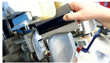
Fig. 8: Forma matritei trebuie să fie identică cu a calapodului © PFI
