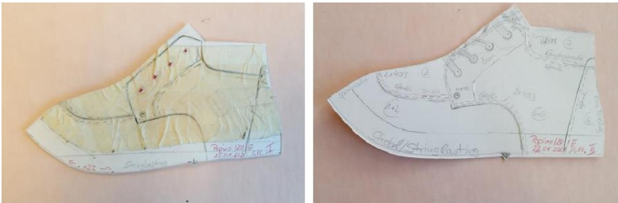
Fig. 3: Plano base para levantamento de moldes. © PFI
