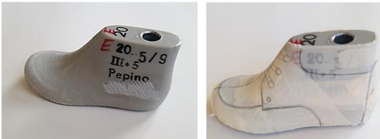
Fig. 2: Forma e forma com fita adesiva para planificação da forma © PFI
