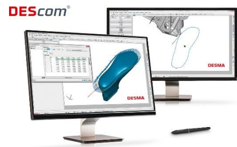
Fig. 5: Sistema CAM DEScom da DESMA; Programação de um ciclo de desbaste baseado em dados 3D-CAD; visualização do caminho e orientação da ferramenta. (Imagens fornecidas pela DESMA)
