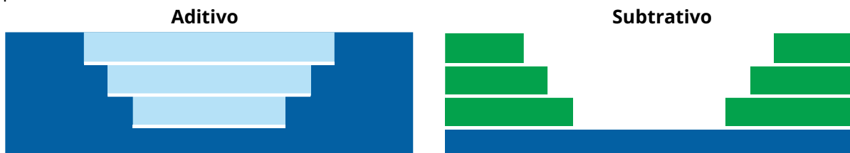
Fig. 7: Esquerda: processo subtrativo (azul-escuro: produto desejado, azul claro: material removido) | direita: processo aditivo (azul escuro: camada de base, verde: camadas adicionadas) © PFI
