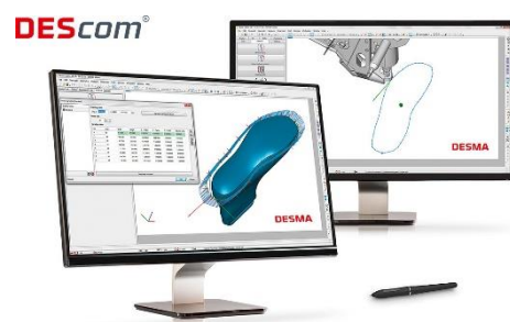
Abb. 5: CAM-System DEScom von DESMA; Programmierung eines Schrappzyklus auf Basis von 3D-CAD-Daten; Visualisierung der Werkzeugbahn und -orientierung. (Bild von DESMA)
