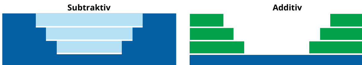
Abb. 7: links: subtraktiver Prozess (dunkelblau: gewünschter Teil, hellblau: entferntes Material) rechts: additiver Prozess (dunkelblau: Basisschicht, grün: hinzugefügte Schichten) © PFI
