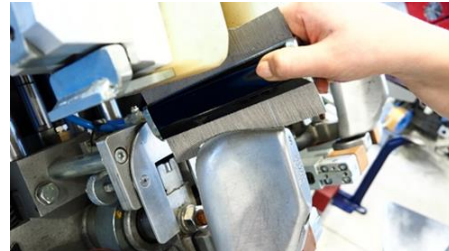
Abb. 8: Die Form der Schablone muss mit der letzten Ausführung identisch sein. © PFI
