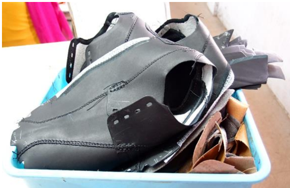
Abb. 9: Zufällige Position des Teils erhöht die Suchzeit © PFI
