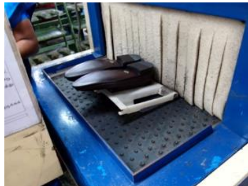
Abb. 39: Lösung, um Hitze oder Kälte auf der Sohle zu erhöhen © PFI
