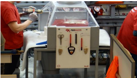
Abb. 24: Platzierung der für die eigentliche Arbeit benötigten Werkzeuge © PFI
